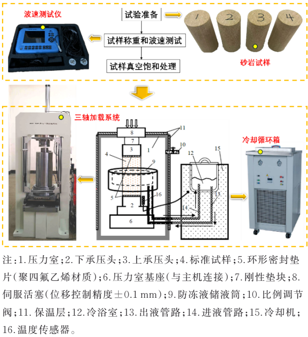
图 1 RLW-2000 岩石三轴仪及冷却系统示意图
